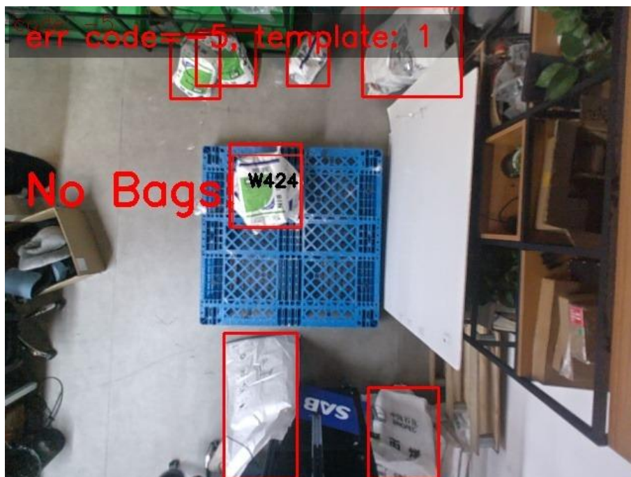
图 17 顶层包垛异常·长度不对（红框为尺寸不符、无法抓取的软包）
